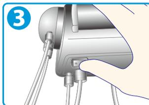
3 洗剤供給装置の電源を切る。
